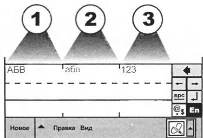
Панель ввода: 1 — область для ввода заглавных букв; 2 — область для ввода строчных букв; 3 — область для ввода цифр
